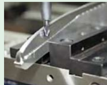
Fresatura di un pattino del bob di Sandra Kiriasis con sistema di controllo Siemens
